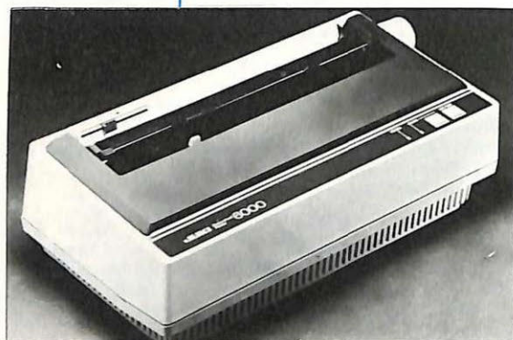
Le due stampanti Juki: modello 5510 a matrice di punti e 6000 a margherita.
